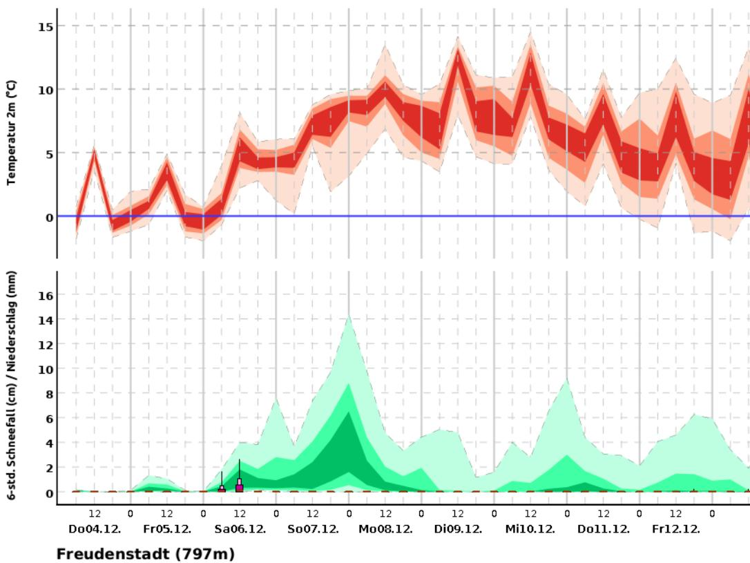
Erläuterung: Die Trendvorhersage beschreibt, in welchem Rahmen sich Temperatur und Niederschlag/ Schneefall entwickeln werden. Dazu werden mehrere Vorhersagen berechnet, die möglichst alle potenziell zu erwartenden Entwicklungen umfassen sollen. Die Darstellungen fassen zusammen, in welchem Bereich 50%, 80% bzw. 100% dieser Vorhersagen liegen.
